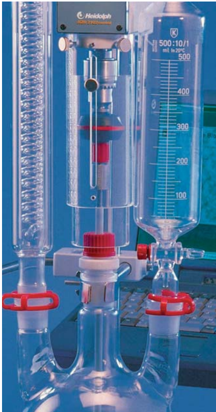
Ejemplo de aplicación de los accesorios: Portavarillas flexible, Guía NS 29/32 y Pantalla de protección.
